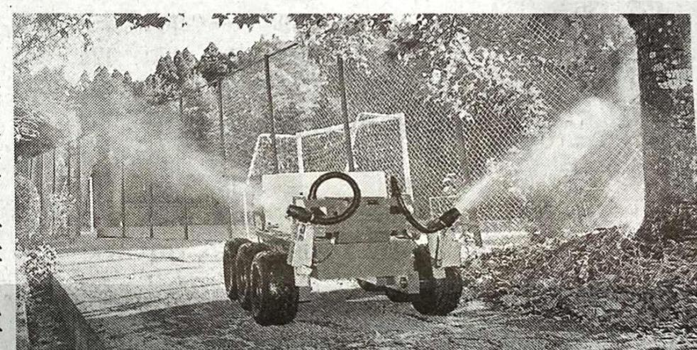
動とライトの点灯、噴射量・圧力の強弱だけで簡単。操作の有効範囲は、電波障害が無い場合で半径1キロ。傾斜は20度まで対応し、その場で車体も回転できる。タンクは取り外しうけ、収穫物や資材など最大150キログラムまでの荷物を運ぶ運搬車としても使える。
